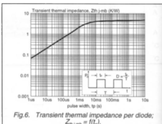
Fig.6. Transient thermal impedance per diode;
